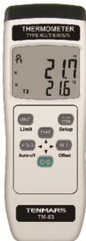
Термометр имеет семь вариантов выбора термопары: K, J, T, E, R, S, N. Выбираемые единицы измерения °C / °F / °K. Большой двойной ЖК-дисплей с подсветкой (T1, T2 или T1-T2), отображает 5 цифр, максимальное индицируемое число 9999,9.
