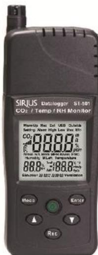
Анализатор TENMARS ST-501 Sirius предназначен для контроля качества воздуха в закрытых помещениях, на производствах и в быту.
